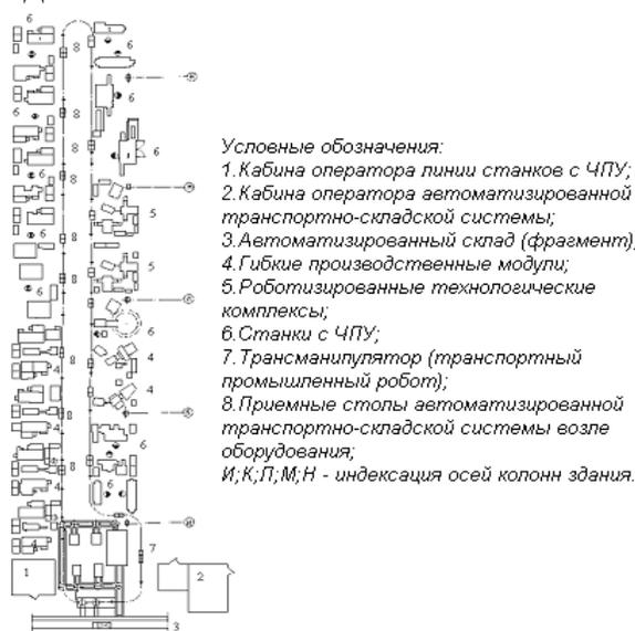
Рисунок 3 – Компоновка линии гибкой производственной системы с двухстаночными ГПМ, РТК и многостаночным обслуживанием станков с ЧПУ
