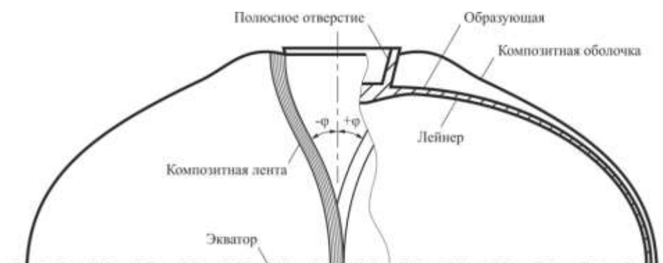
Рис. 2. Схема составляющих металлокомпозитный баллона для газового топлива
