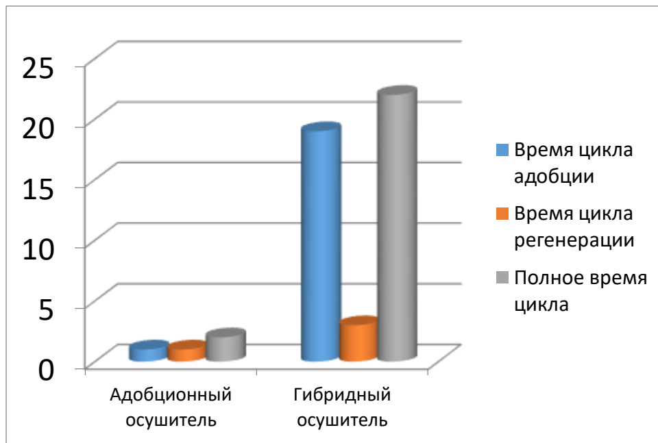
Рис. 3. Схема циклов работы осушителя гибридного(1), адсорбционного(2)
