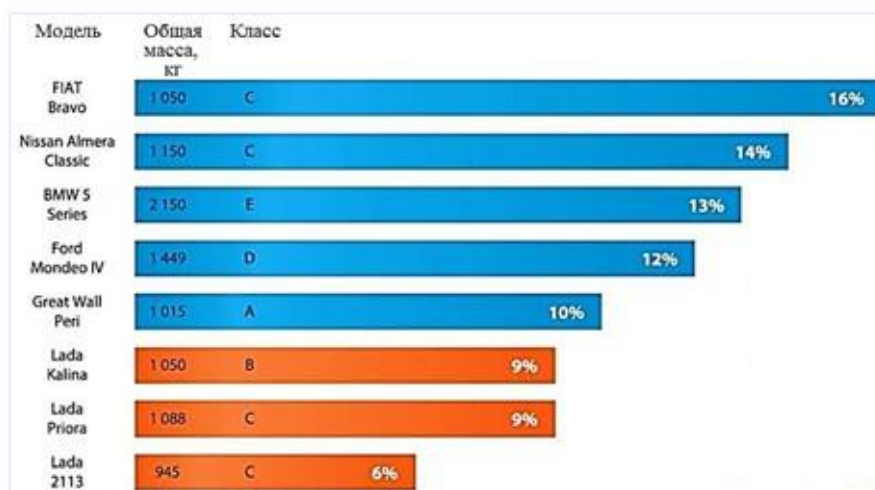
Рисунок 2. Весовое содержание полимеров в различных моделях автомобилей.
