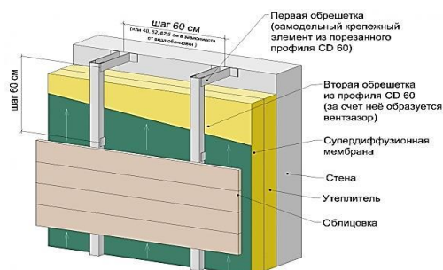
Рисунок 1 – Устройство навесного вентилируемого фасада
