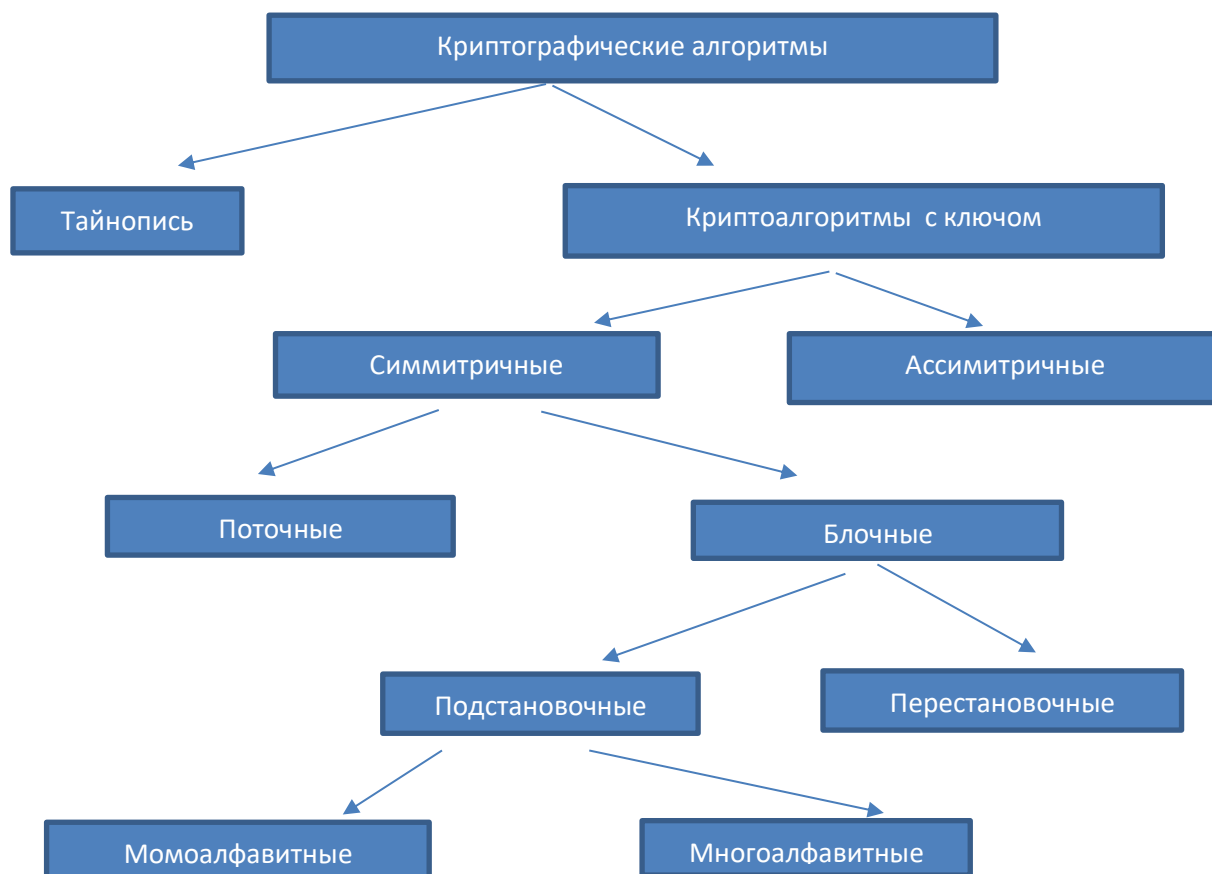
Рис. 1. Общая классификация криптографических алгоритмов
