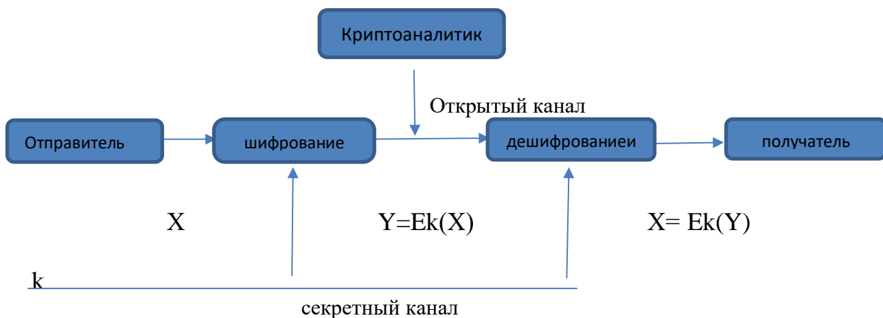
Рис. 2. Обобщенная модель симметричной системы шифрования
