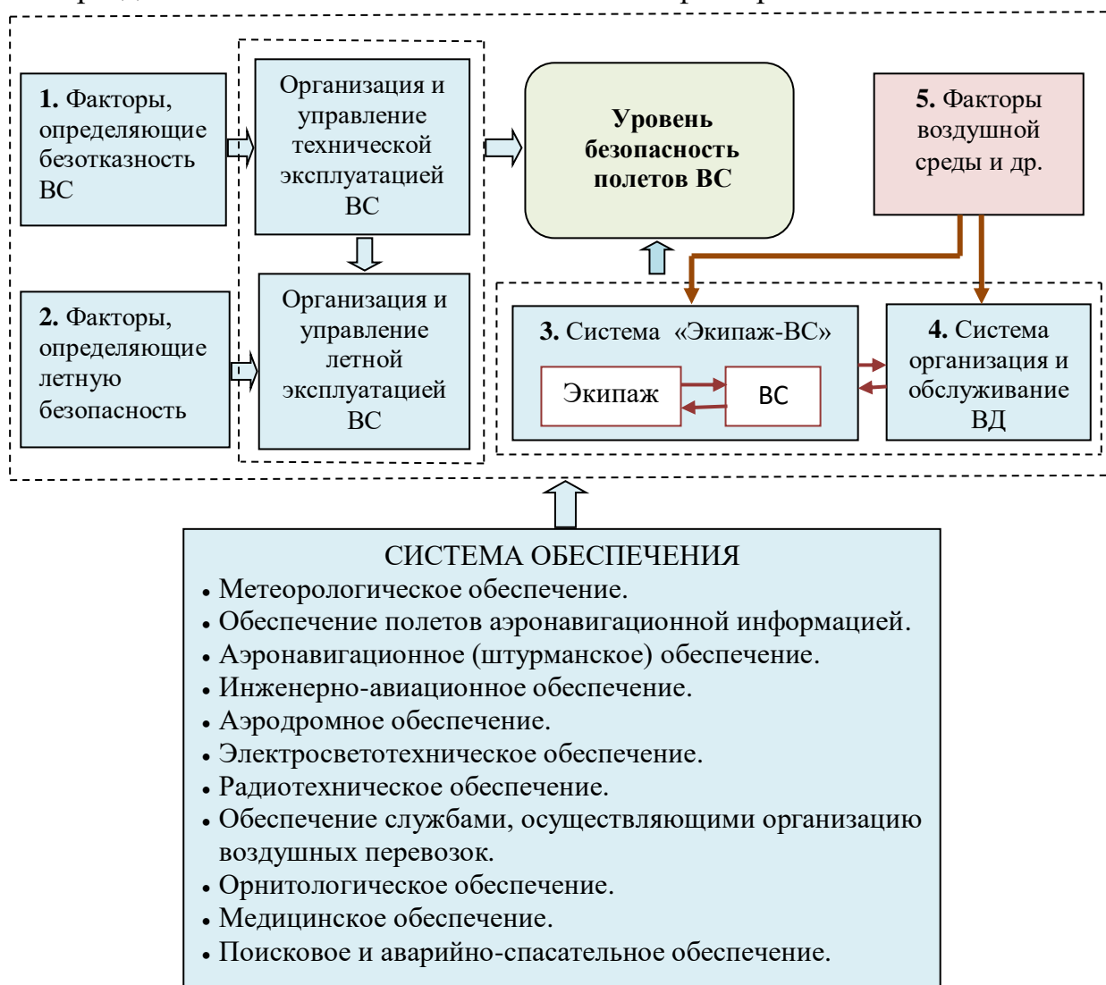
Рис. Блок-схема факторов, определяющих уровень безопасности полетов ВС
