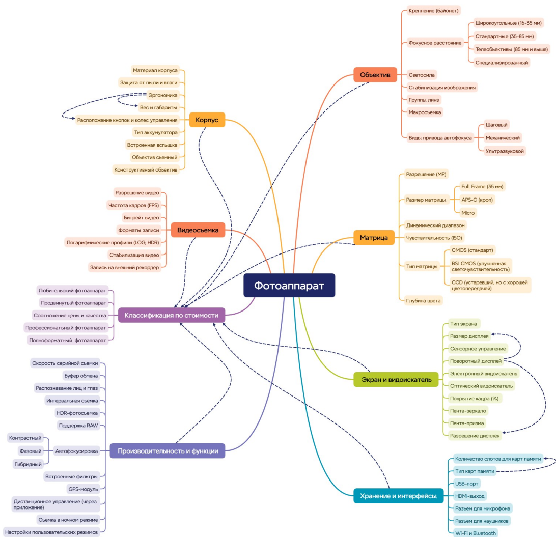
Рисунок 1 — Полная схема параметров фотоаппарата и их взаимосвязей
