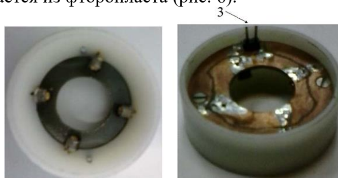
Рис. 6. Насадка с ультрафиолетовыми светодиодами
